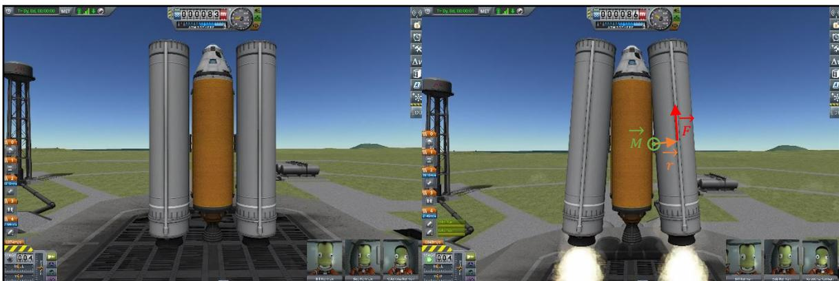
Abbildung 5: Mit dem Start dieser Rakete wirkt die Schubkraft der Booster jeweils ein Drehmoment auf die Aufhängung der Booster, wodurch diese elastisch verformt werden
